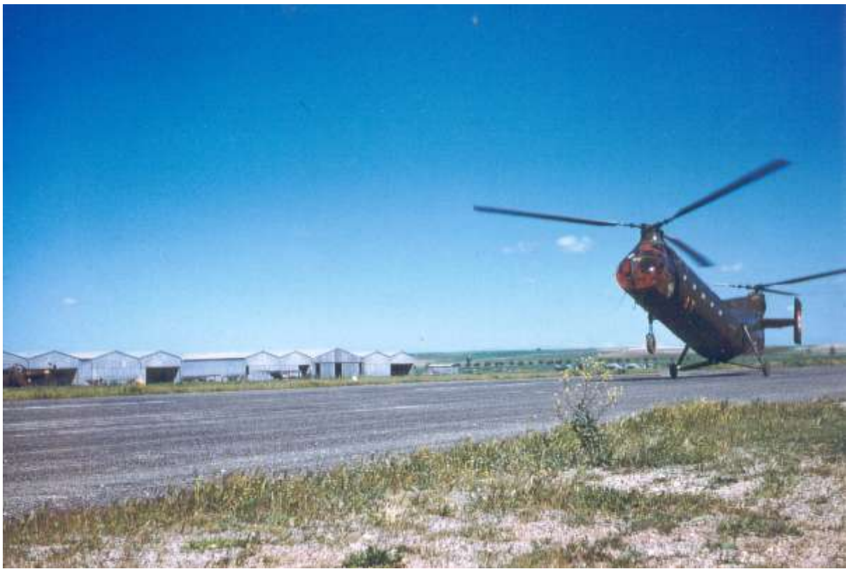
La FR 53 codée AT vue au décollage de l'EA.ALAT de Sidi-Bel-Abbès en 1960. La machine effectue un décollé-roulé sur la piste en dur. Comme les autres machines de l'école, le B de l'indicatif est supprimé. Notez, dans le poste de pilotage les panneaux oranges destinés à l'entraînement au Vol Sans Visibilité (photo X, collection Emmanuel Bosc).
